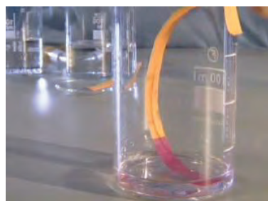
Εικόνα Ε.4 Πεχαμετρικό χαρτί σε υδροχλωρικό οξύ πριν και μετά, αφού ρίξουμε υδροξείδιο του νατρίου
