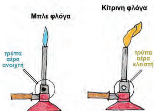
Εικόνα Υ.Κ.13 Καύση λύχνου σε εργαστήριο Χημείας με την τρύπα του αέρα ανοιχτή και κλειστή
