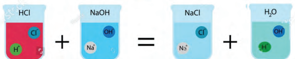
Εικόνα Α.7 Αντίδραση εξουδετέρωσης υδροχλωρικού οξέος και υδροξειδίου νατρίου
